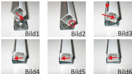
Abbildung 3: Montage mit Klemmhalterung
